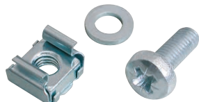
Nakrętka klatkowa M6, wkręt M6x16, podkładka 6,4
