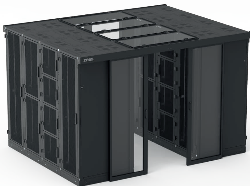
Przykładowa zabudowa Data Box składająca się z: 4 szaf SZB IT 42 U, 800 x 1000 mm, 2 szaf DSR IT 42 U, 800 x 1000 mm z 2 przedziałami, 2 szaf DSR IT 42 U, 800 x 1000 mm z 4 przedziałami, drzwi przesuwnych, płaskiego dachu korytarza. Szafy stoją na cokole o wysokości 100 mm.
