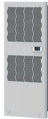
SLIM Klimatyzator mocowany w drzwiach lub osłonie bocznej z możliwością częściowego lub całkowitego wpuszczenia do wnętrza szafy. Moc chłodząca od 550 do 4000 W
