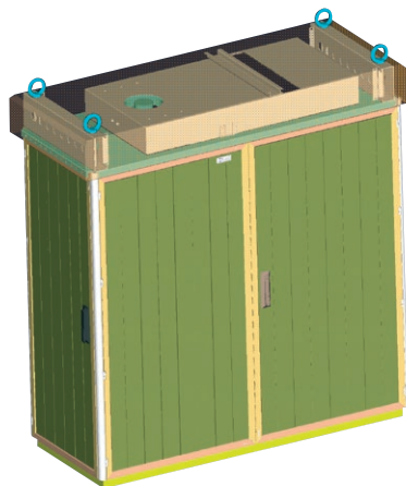
Szafa z wymiennikiem ciepła w dachu
