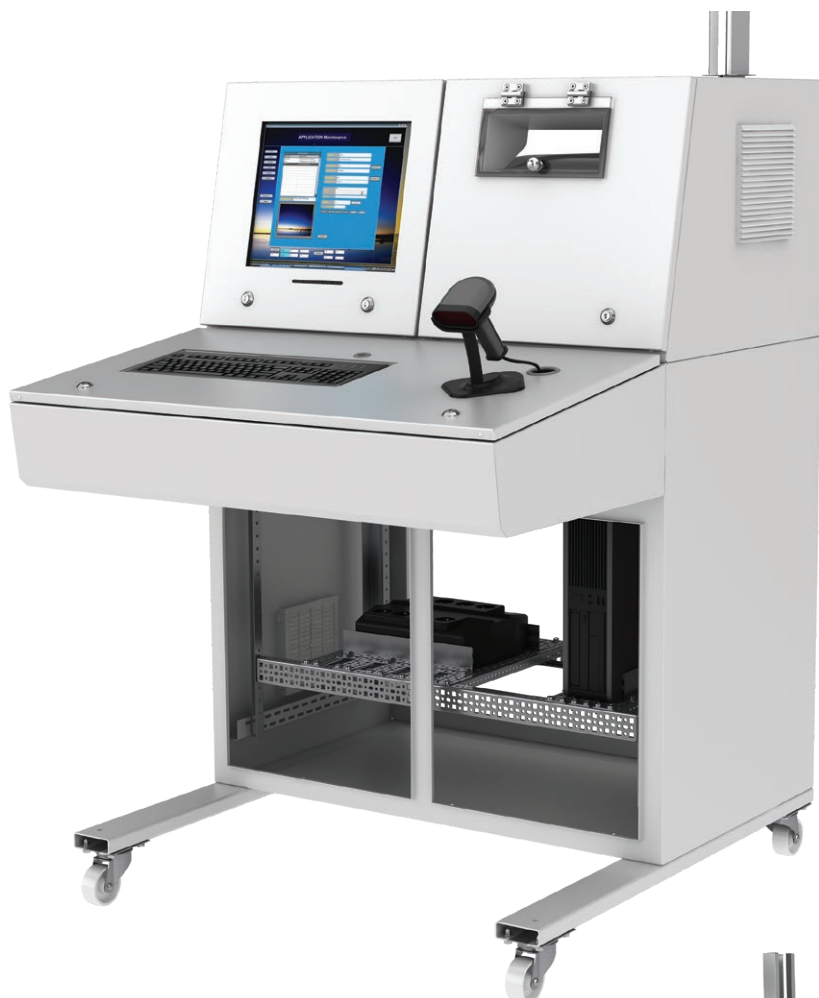
PSL-Steuerpult auf Rollen, ausgestattet mit: Gestell aus Montageschienen, PC, UPS, Barcode-Leser, Laserdrucker und WiFi-Antenne.
