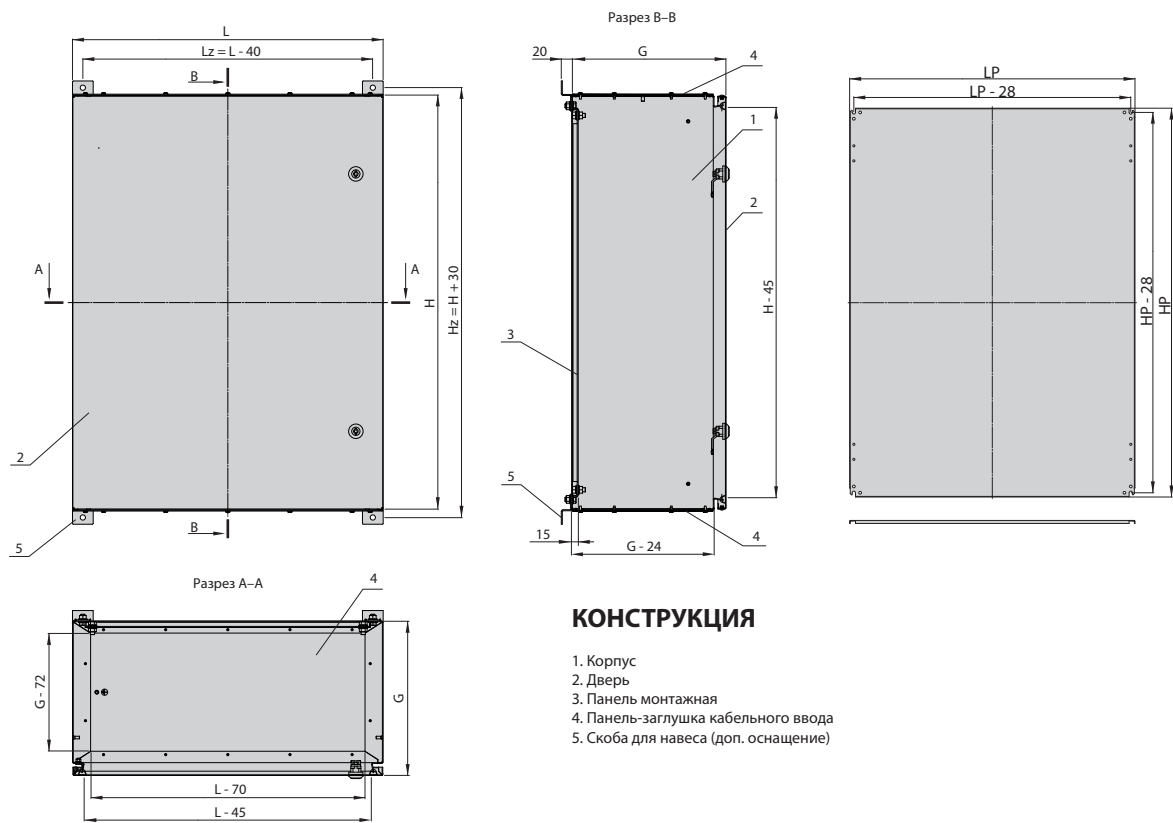
Основные размеры и элементы конструкции шкафов SWN с двумя заглушками
